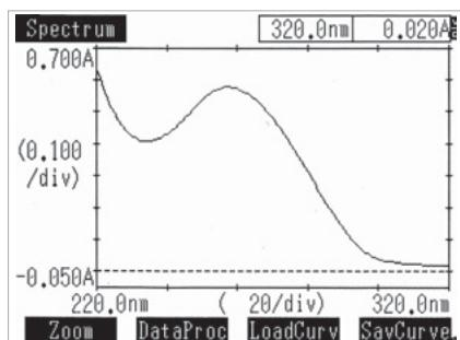
Спектральное измерение образца двухцепочечной ДНК объемом 100 мкл проводили, используя держатель для супермикрокювет. Для измерений в обычной 10 мм кювете понадобилось бы примерно 3,5 мл образца. Однако супермикрокювета позволяет проводить измерения от 100 до 200 мкл образца.
