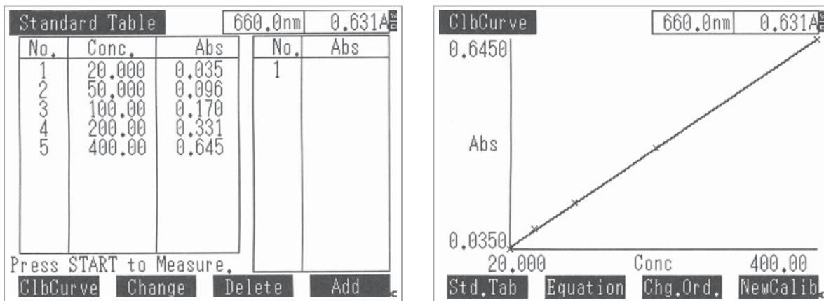
Согласно JIS K0101 готовили стандартный раствор формазина. Измеряли оптическую плотность при 660 нм и строили калибровочную кривую. Для растворов с мутностью от 4 до 80 единиц мутности использовали прямоугольную кювету с длиной оптического пути 50 мм, для растворов с мутностью от 20 до 400 единиц мутности — кювету с длиной оптического пути 10 мм.
