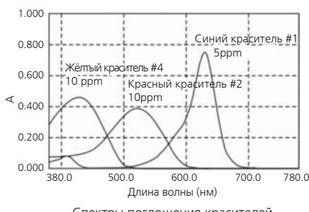
Концентрации красителей (интенсивность цвета) определяли измеряя коэффициенты поглощения. Обычно значение цвета определяется путем измерения оптической плотности при длине волны, при которой происходит максимальное поглощение в видимой области спектра в растворе с пищевым красителем, а затем проводится преобразование полученного значения к оптической плотности для 10% вес /об раствора ( $E10\% 1\text{ см}$ ).
